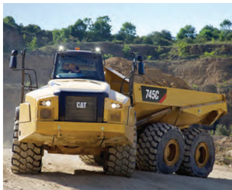
Slika 3: Levo zgibni, desno togi demper (Vir: arhiv avtorja)
