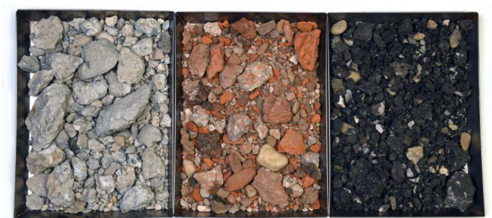
Slika 4: Sekundarne surovine za proizvodnjo recikiranega agregata iz betonskih ruševin, mešanih ruševin in asfaltnega rezkanca
