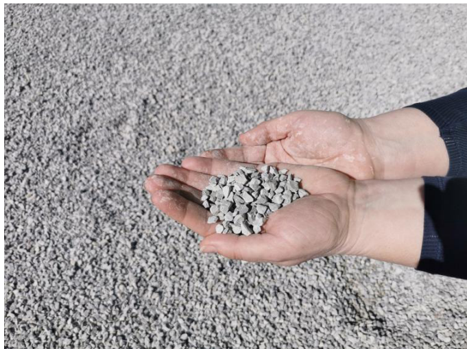
Slika 5: Kvalitetni agregat, proizveden kot stranski proizvod izkopa za infrastrukturni objekt drugega tira Divača-Koper
