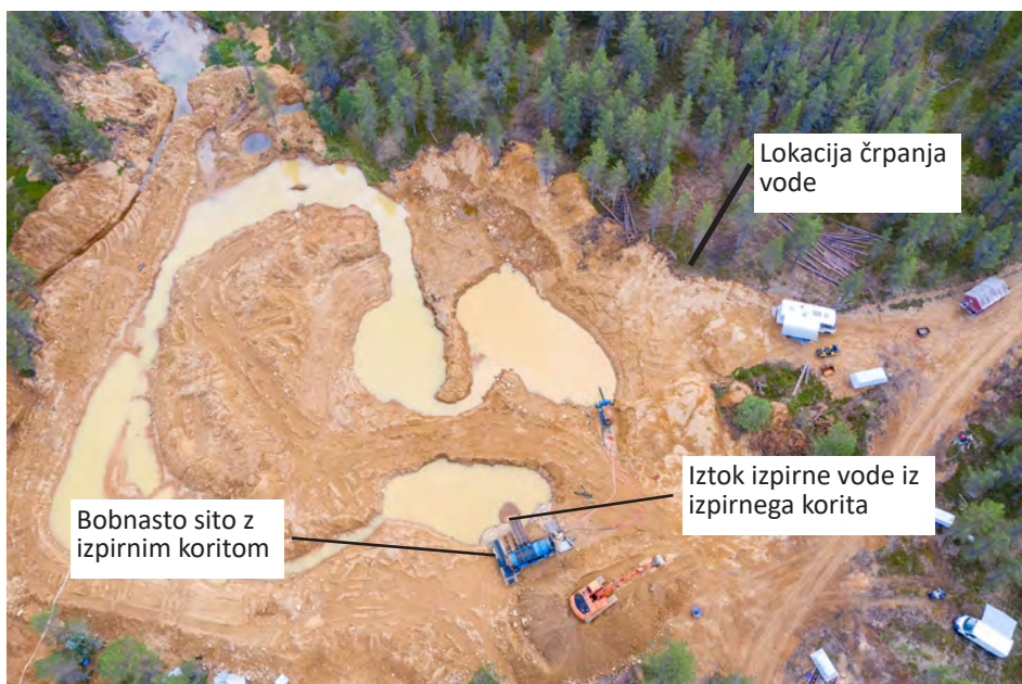
Slika 2: Običajno kroženje izpirne vode v primeru pridobivanja aluvialnega zlata (foto: Antje Neumann)
