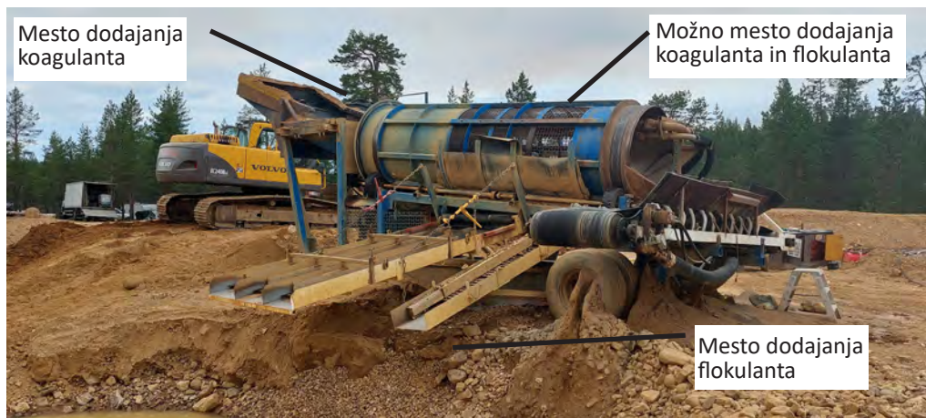
Slika 5: Izpirno korito uporabljeno na lokaciji »Kuninkaitten laakso« v pilotnem poskusu s flokulantom (foto: dr. Esther Takaluoma)
