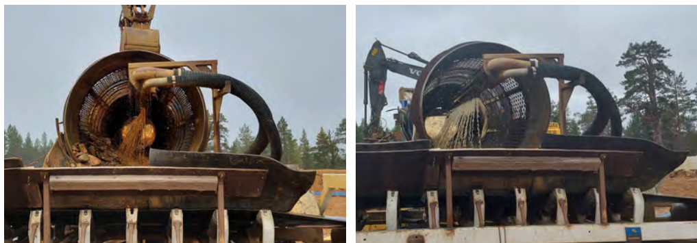
Slika 6: Bobnasto sito med postopkom izpiranja zlata, levo in desno v pilotnem poskusu s flokulantom (foto: dr. Esther Takaluoma)
