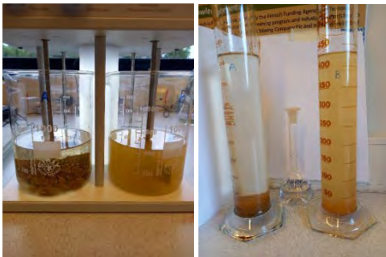
Slika 3: JAR-test z 200 \mu L PIX 105 in 20 ml 0,1 % Praestola 2500 TR, desno vzorec iz »Rove Vero«, levo vzorec iz »Kuninkaitten laakso« (foto: dr. Esther Takaluoma)
