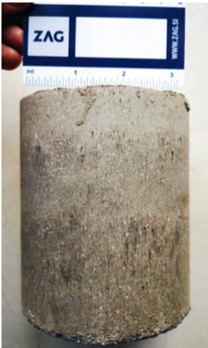
Slika 3: Vzorec kompozita iz predelanega blata, z dodatkom kalcijskega pepela
