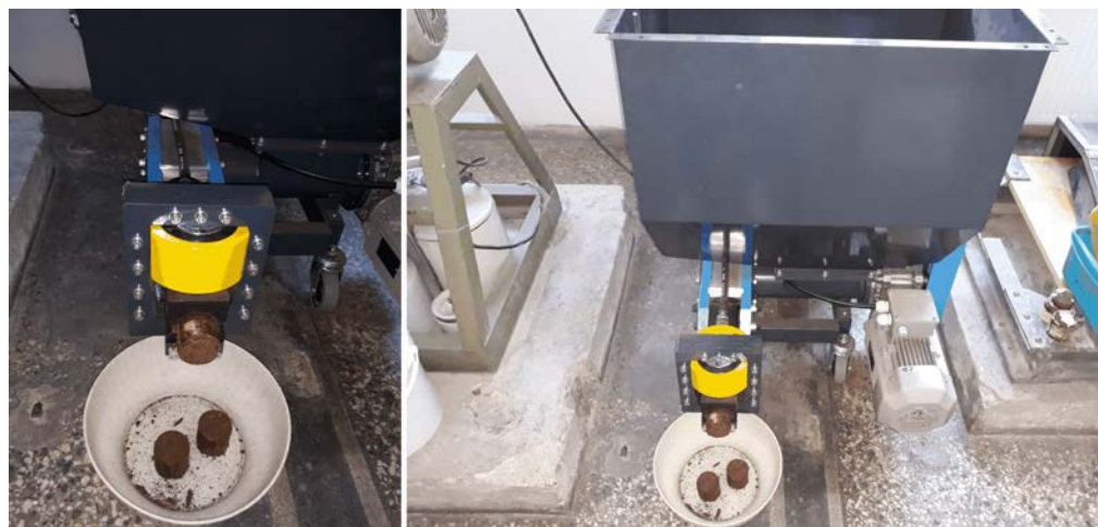
Slika 4: Hidravlična briketirna stiskalnica - laboratorij Naravoslovnotehniške fakultete [1]
