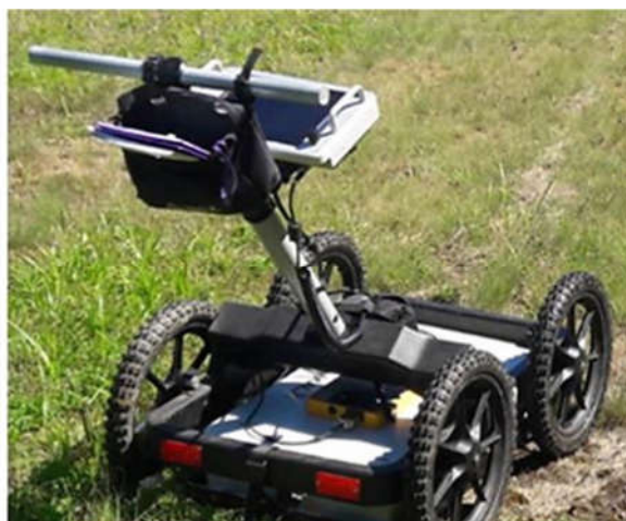
Slika 2.1. Georadarska oprema proizvajalca MALÅ z antenami različnih frekvenc, v lasti podjetja Vitrum laser d.o.o.
