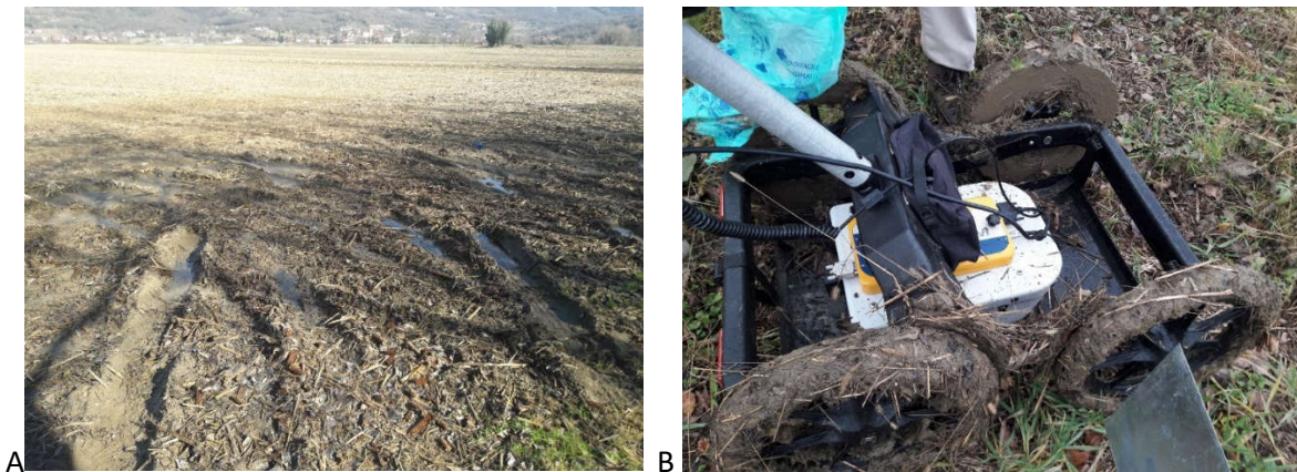
Slika 4.2. Neugodno površinsko stanje za georadarske meritve. A – stoječe vode na površini; B – oteženo premikanje z georadarsko opremo.
