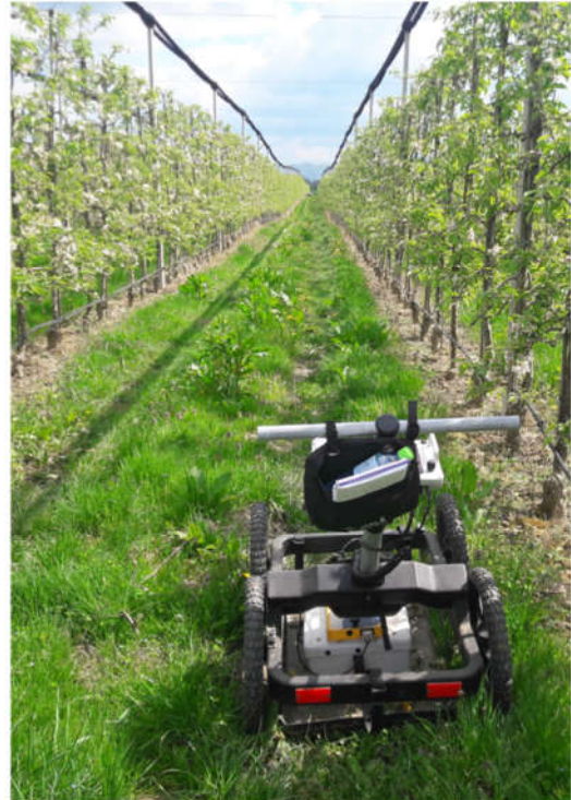
Slika 3.1.11: Georadarske meritve s 500 MHz anteno. Levo – prazna njiva; desno – sadovnjak.
